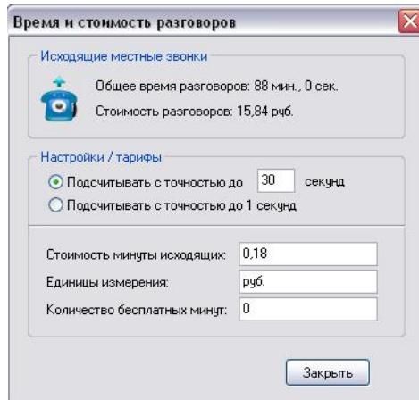
Для исходящих местных звонков автоматически подсчитывается стоимость разговора на основе значения поля «Стоимость минуты исходящих». Если в поле «Количество бесплатных минут» введено значение больше нуля, это значение будет вычитаться из общего времени исходящих местных звонков при подсчете стоимости разговоров. Данная функция нужна, если выбран тариф, где есть предоплаченные минуты исходящих местных звонков.
