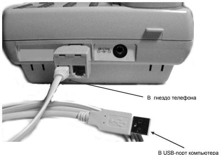
По-умолчанию, после установки, программа Virtual Phone настроена на автоматическое определение, к какому COM-порту компьютера был подключен телефон. При подключении телефона к компьютеру через USB-порт, в системе появляется дополнительный COM-порт (программа Virtual Phone должна быть установлена, см. выше). Если телефон включен в сеть 220 вольт, либо питается от резервных батарей, связь с запущенной программой Virtual Phone будет установлена через несколько секунд.
