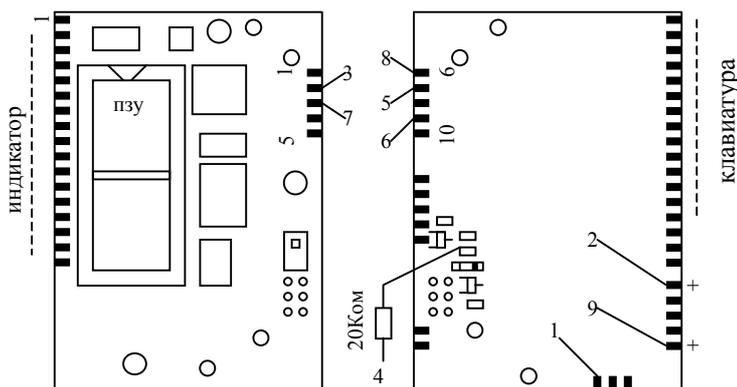
Вариант установки плат цифрового автоответчика к плате VENUS-2
